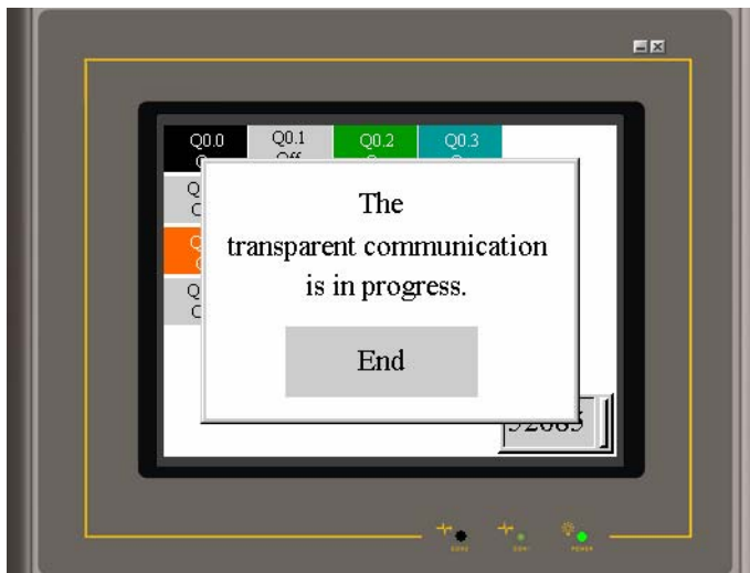
觸控屏穿透通訊_啟動畫面
